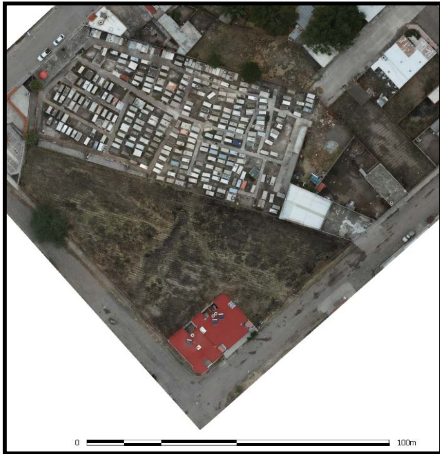
Ilustración 18. Ortofoto Cementerio de Mezcala. Resolución 1.4 cm./Pixel
