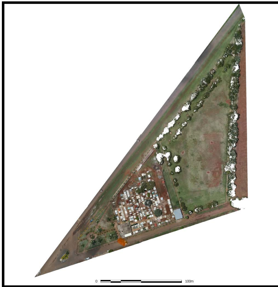
Ilustración 26. Ortofoto. Resolución 1.4 cm/pixel
